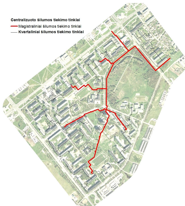
10.1 pav. Magistralinių šilumos tiekimo vamzdynų schema
